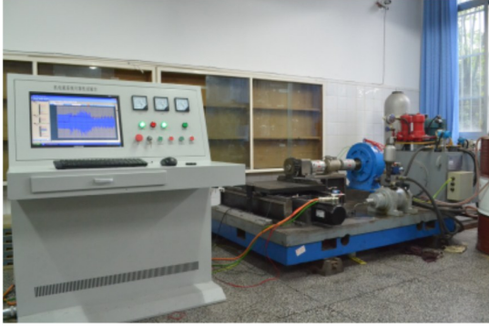
图2 滚珠丝杠副加速寿命实验系统
