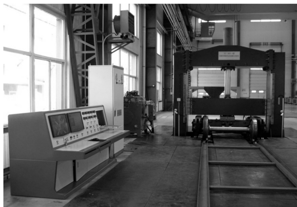
图 1 高速重载铁路货车轮轴智能检测设备
