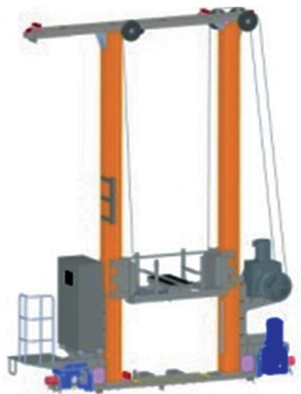
图 10 堆垛机示意图
