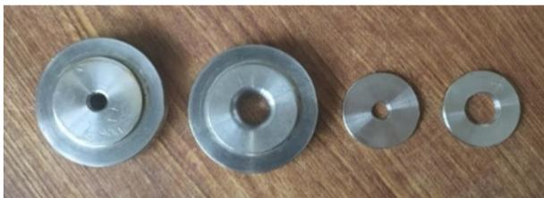
图 4 节流孔板实物图
