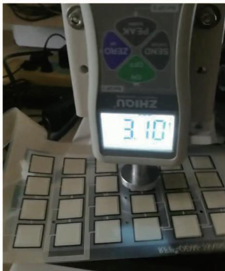
图2 柔性薄膜阵列压力传感器
