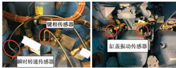
图 12 现场测试传感器安装图
