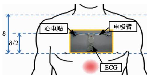
图 2 ECG 设备穿戴示意图
