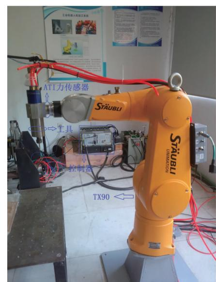
图 2 TX-90 工业机器人系统
