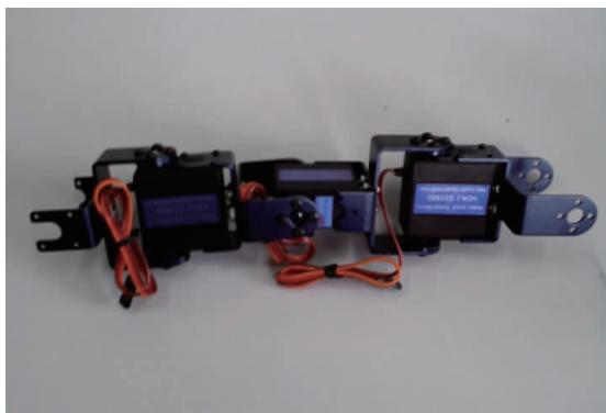
图 7 蛇形机器人正交串联关节模块
