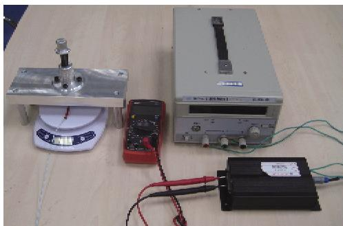
图5 导电橡胶传感器标定
