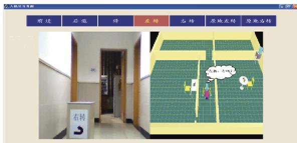
图10 机器人移动过程中的人机协作界面
